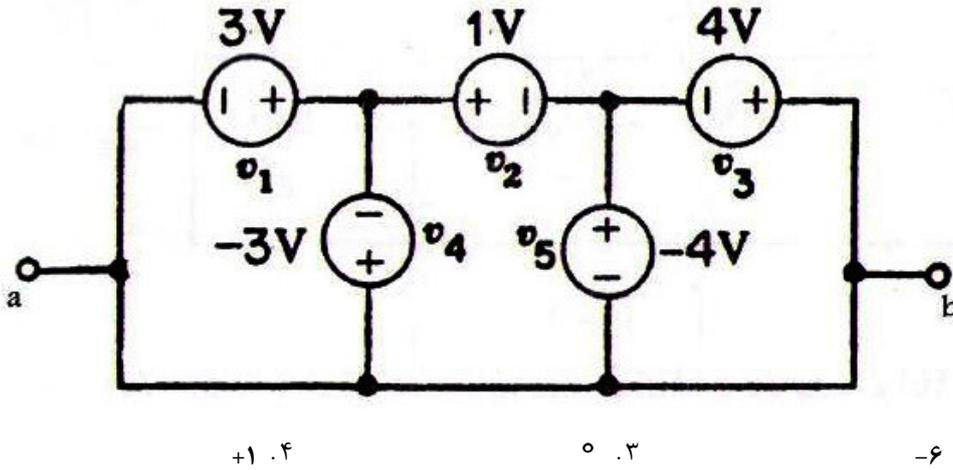
۵- در مدار زیر اگر  $v_1 = 2V$  باشد،  $v_s$  چند ولت است؟
