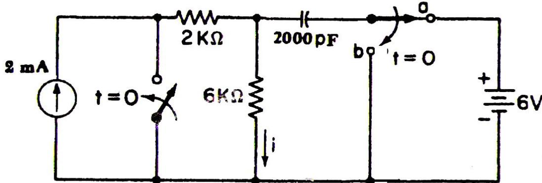
۴- در مدار الکتریکی زیر فرض کنید  $V_c(0) = 0$  و  $i_L(0) = 0.6$  باشد. جریان  $i_2$  را به دست آورید.
